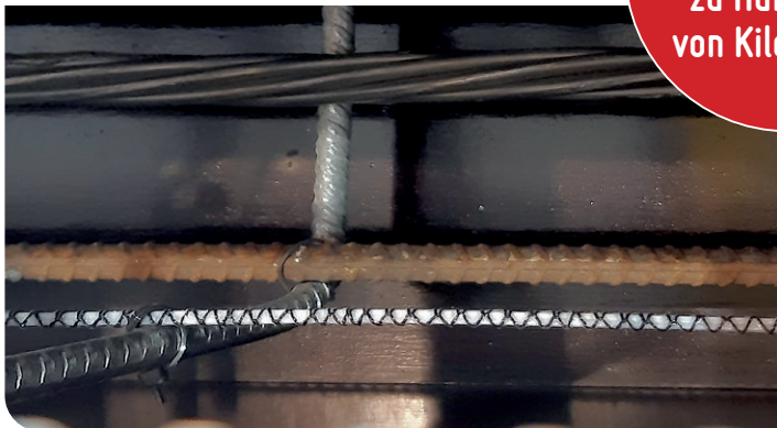
Spannbetonträger mit EpsilonSensor
