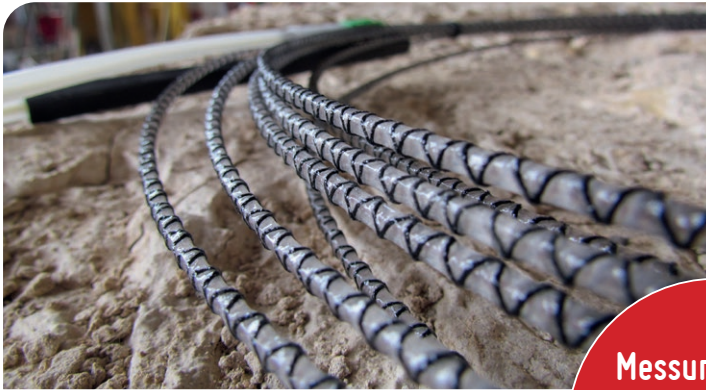
EpsilonSensor vor dem Einbau in einen Probekörper
